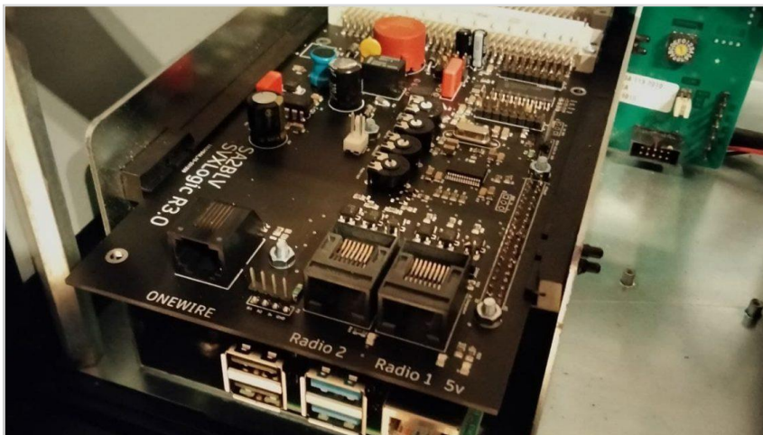
SA2BLV's kort, monterat inuti en Ericsson F800 repeater. Raspberry Pi skymtar undertill. Klicka på bilden för att läsa mera om kortet.
